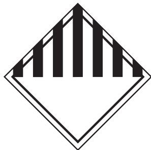
TMP - 14 RIESGOS DISTINTOS A LOS ESPECIFICADOS ANTERIORMENTE
