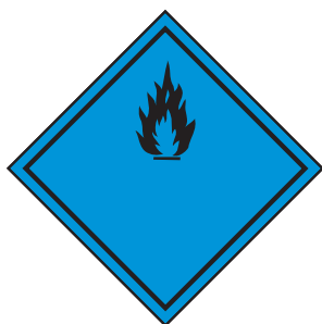
TMP - 05 EMANACION DE GAS INFLAMABLE AL CONTACTO CON EL AGUA
